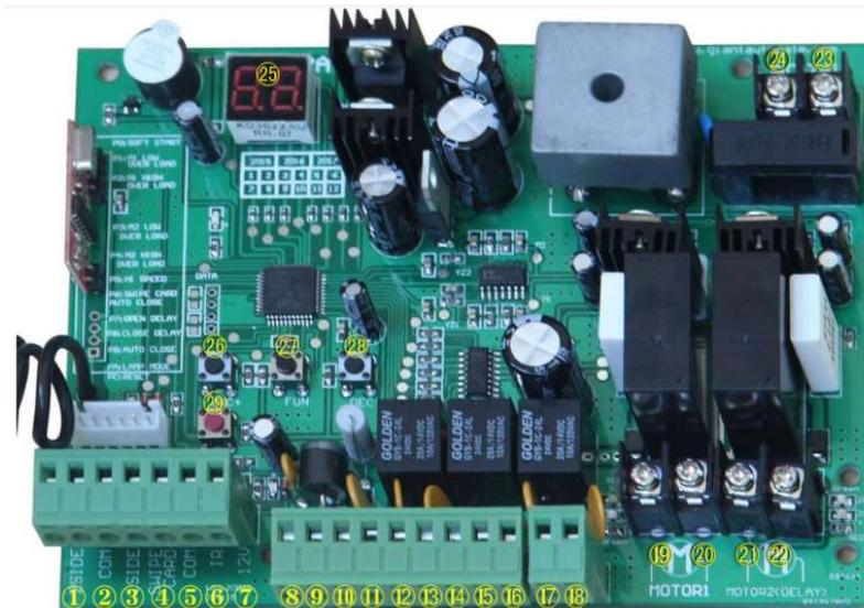
1. El terminal 2 SIDE se utiliza para conectar cualquier dispositivo externo que opere con doble puerta
